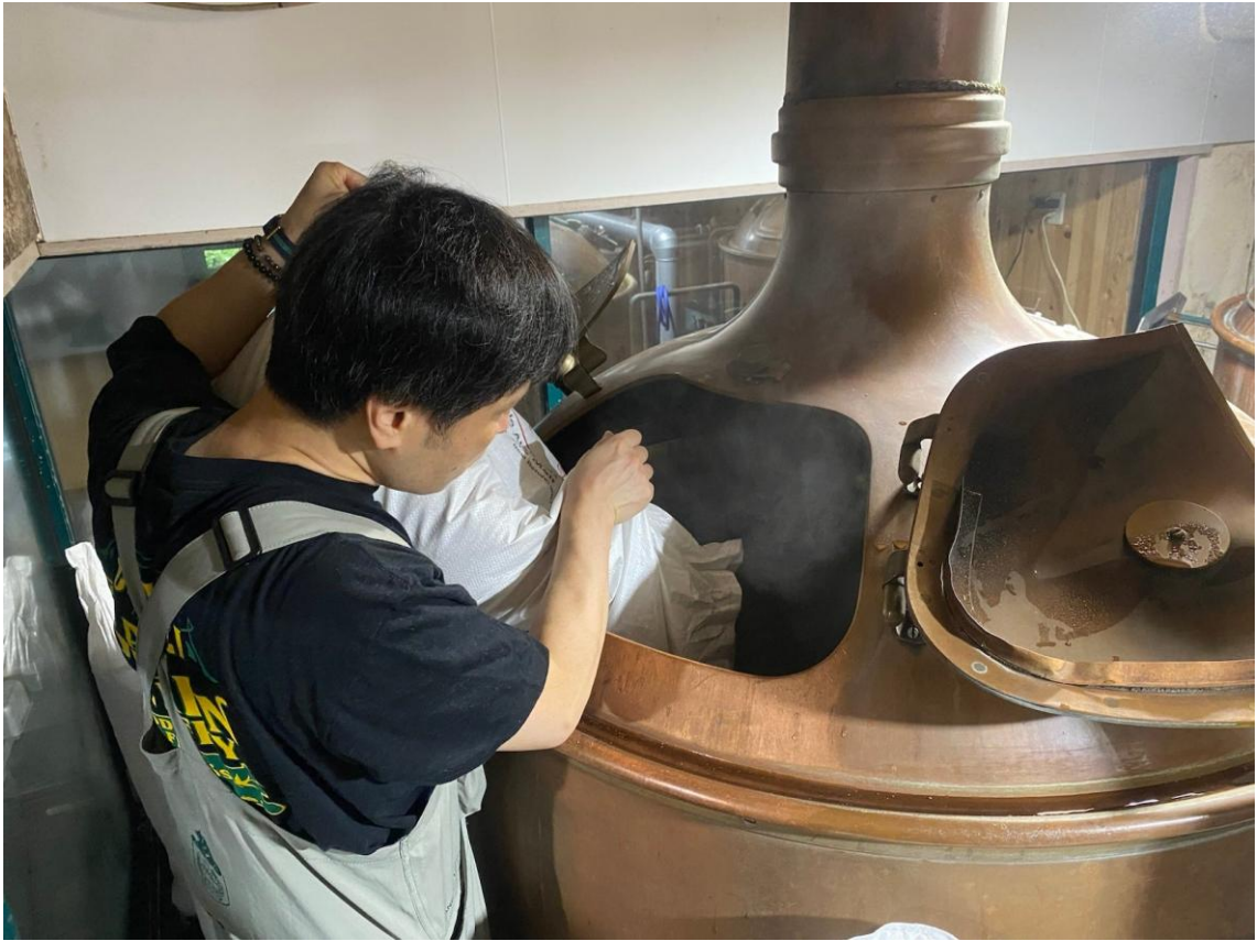
仕込み釜投入
